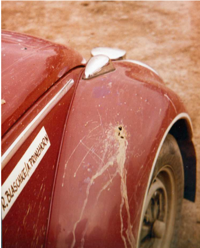
Ein Materialfehler. Rost plus Steinschlag.
